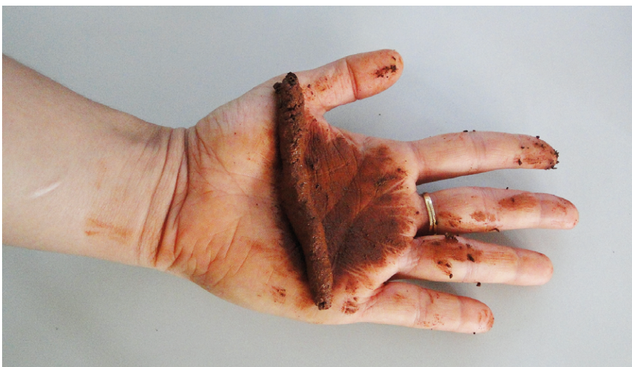
FIGURA 31. Aspecto do solo argiloso (pouco permeável). Detalhe da cobrinha, que teve seu formato mantido, e da mão tingida (Foto: Isabel Figueiredo).
