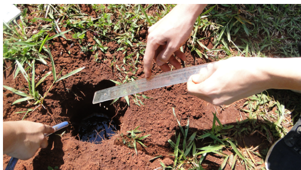
FIGURA 1. Medida da altura da coluna de água dentro do buraco, com auxílio de uma régua (Foto: Jerusa Schneider).
