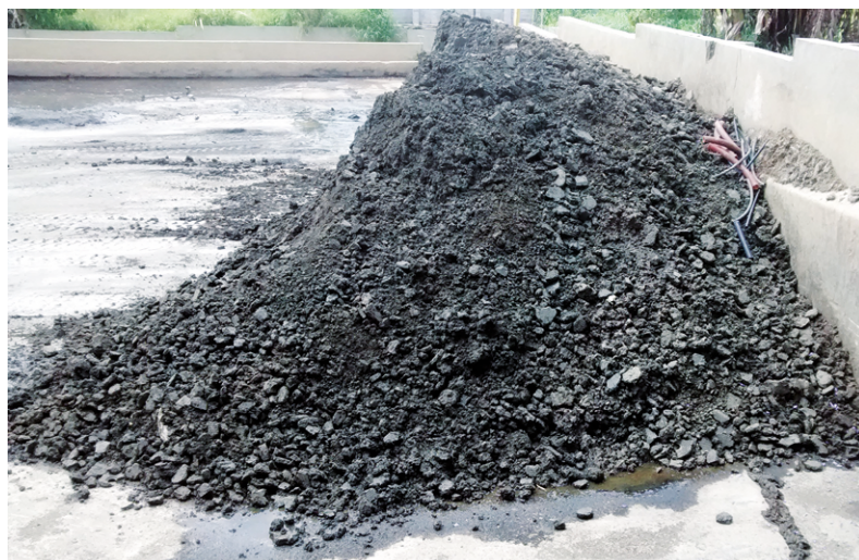
FIGURA 45. Aspecto do lodo seco em leito de secagem em ETE (Foto: Natalia C. Duarte).
