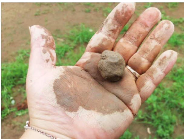
FIGURA 32A. Aspecto do solo muito argiloso (impermeável). Detalhe da mão tingida. (Foto: Rachel Germiniani Resende).
