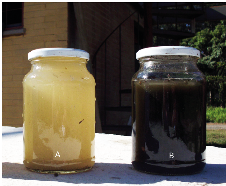
FIGURA 37. Lodo de tanque séptico (A) e de filtro anaeróbio (B) de sistemas descentralizado de tratamento de esgoto em Campinas-SP (Foto: Bianca Gomes).
