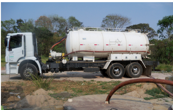
FIGURA 4. Caminhão tipo “limpa-fossa” fazendo a limpeza programada do tanque séptico, conforme definido em projeto. Campinas-SP (Foto: Luana Cruz).
